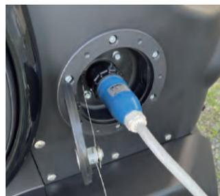
家庭用の100V電源から車体の給電口にコンセントを繋ぐだけで充電ができる。
