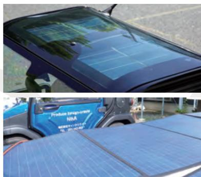
オプションの車体天井部のソーラーパネルと折り畳み式のソーラーパネル。
